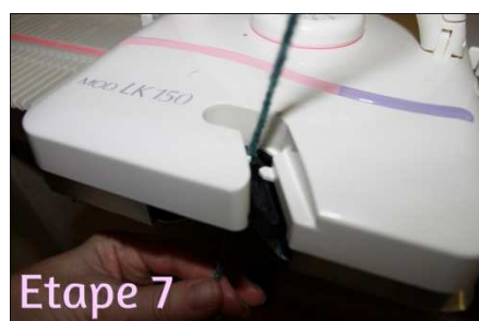
Insérer la laine dans le chariot
