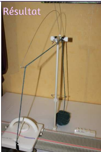
Passer la laine dans la tige de tension
