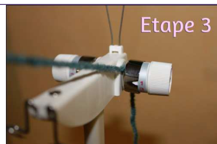
Régler la tension du fil
